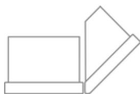
135° Ecke bestehend aus einem Eckelement und einem geraden Element.
