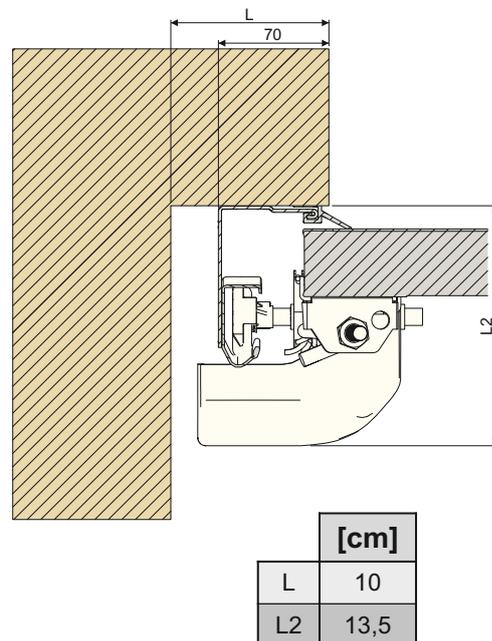
Im Öffnungszustand nimmt das Bodenpaneel 2-3 cm der lichten Höhe ein. Seilhalterung, Seitenscharniere und Innengriff können bis 8.5-9 cm einnehmen.
