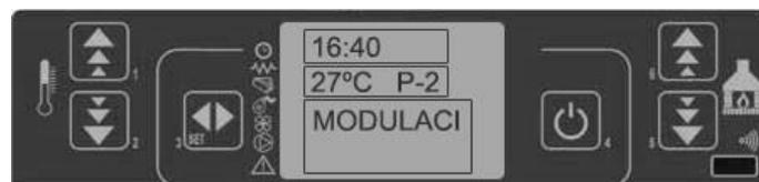
35. panel de mandos - modulación de temperatura configurada
