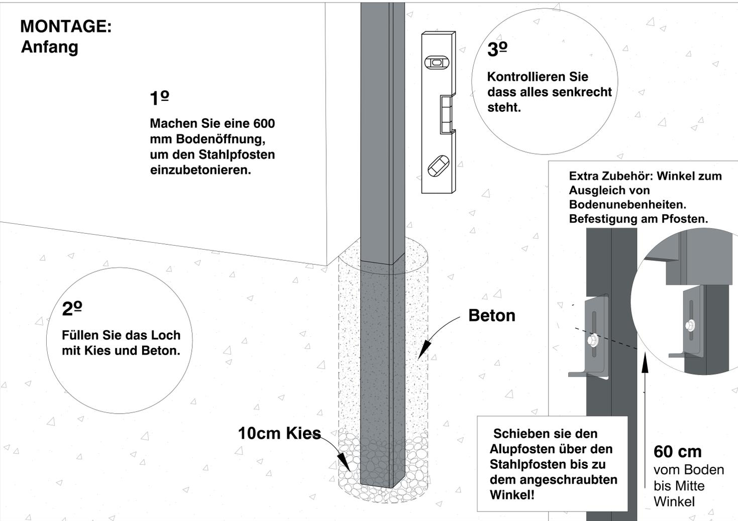
Extra Zubehör: Winkel zum Ausgleich von Bodenunebenheiten. Befestigung am Pfosten.
