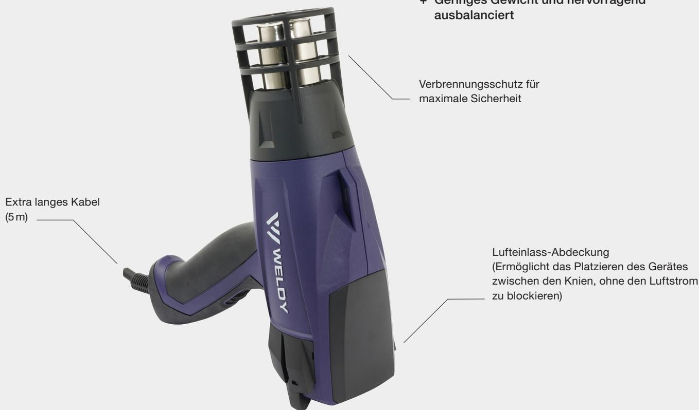
Der HG 330-B ist ein leistungsstarkes Heißluftgebläse von Weldy und verfügt über zwei Temperatur-Schnellschaltstufen für die Wahl zwischen 350 °C und 550 °C, wodurch er die Anforderungen an nahezu alle Fach- und Heimwerkerarbeiten erfüllt. Der Verbrennungsschutz erwärmt sich auf maximal 80 °C, selbst wenn das Gerät seine Höchsttemperatur erreicht hat. Dieses Zubehör schützt den Anwender vor möglichen Verbrennungen und das Material vor Beschädigungen.
