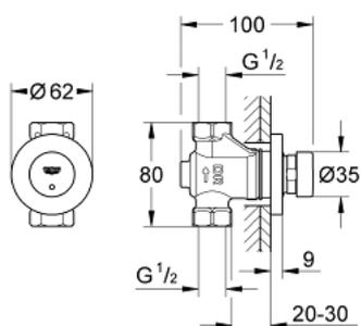
36 268 000 **SELBSTSCHLUSS-DURCHGANGSVENTIL, 1/2"**
