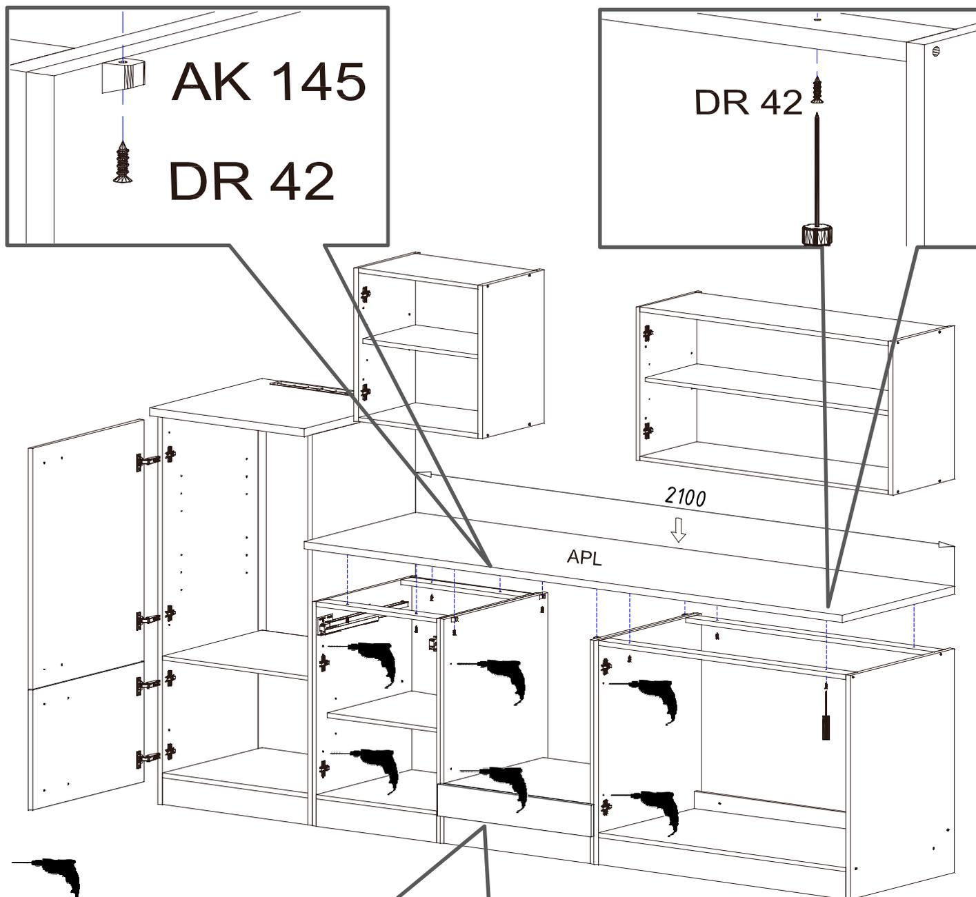
Mit Ø5mm Bohrer durchbohren
