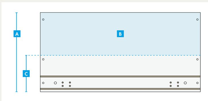
Die Wandnischen können in Ihrer Standardtiefe (350 mm **A**) gekürzt werden, um geringere Einbautiefen zu erstellen. Hierbei werden die vier Einbauteile an der hinteren Seite **B** (Fläche ohne Nuten!) abgesägt. Der Schnitt muss exakt und gerade sein, damit die Rückwand perfekt sitzt. Dafür eine Kreissäge mit Führungsschiene oder Parallelanschlag verwenden **1**. Die geringere Tiefe muss mindestens 180 mm **C** betragen.
