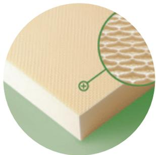
Gewaffelte Extruderschaumplatten mit durchschnittlich **50% Recyclinganteil\*** produziert, geschäumt mit CO<sub>2</sub>, Zellgas Luft, Kantenausbildung: Gerade Kante (I)
