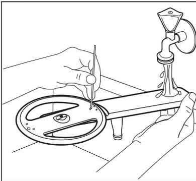
3. Para instalar el brazo aspersor inferior, presiónelo hacia abajo.
