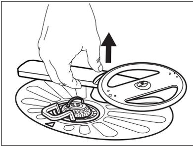
2. Lávelo con agua corriente. Retire las partículas de suciedad de los orificios mediante un objeto afilado, como un palillo.
