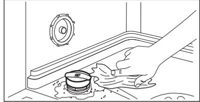
6. Gire la tapa del depósito de sal hacia la derecha para cerrar el depósito de sal.
