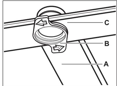
1. Suelte los topes de los lados de los carriles deslizantes del cajón de cubiertos y extraiga el cajón.
