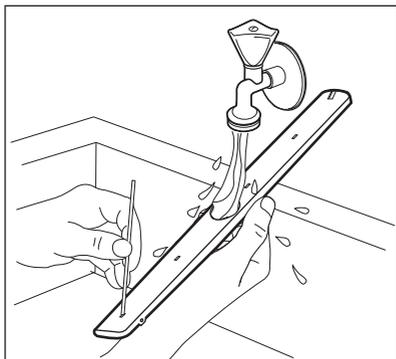
5. Para volver a instalar el brazo aspersor, inserte el elemento de montaje en el brazo aspersor y fíjelo en el tubo de entrega girándolo en el sentido de las agujas del reloj. Asegúrese de que el elemento de montaje encaja en su sitio.
