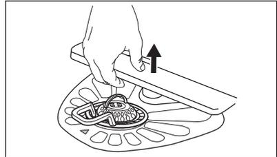
2. Lávelo con agua corriente. Retire las partículas de suciedad de los orificios mediante un objeto afilado, como un palillo.
