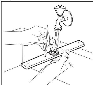
4. Para instalar el brazo aspersor de nuevo, inserte el elemento de montaje en el brazo aspersor y fíjelo en el tubo girándolo en sentido contrario a las manecillas del reloj. Asegúrese de que el elemento de montaje encaje en su sitio.
