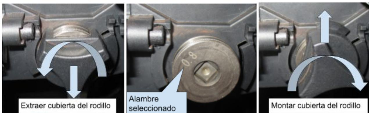
Tensor del rodillo. Este debe realizar la presión adecuada para el correcto arrastre del alambre, una presión excesiva puede ocasionar que el alambre se enrede y el sistema de arrastre trabaje mal. se deberá ajustar de manera que el alambre patine si este queda bloqueado. Se deberá tener especial atención al usar la ranura de 0,8mm, esta es ranurada para el alambre tubular y la fuerza del tensor ha de ser mínima.
