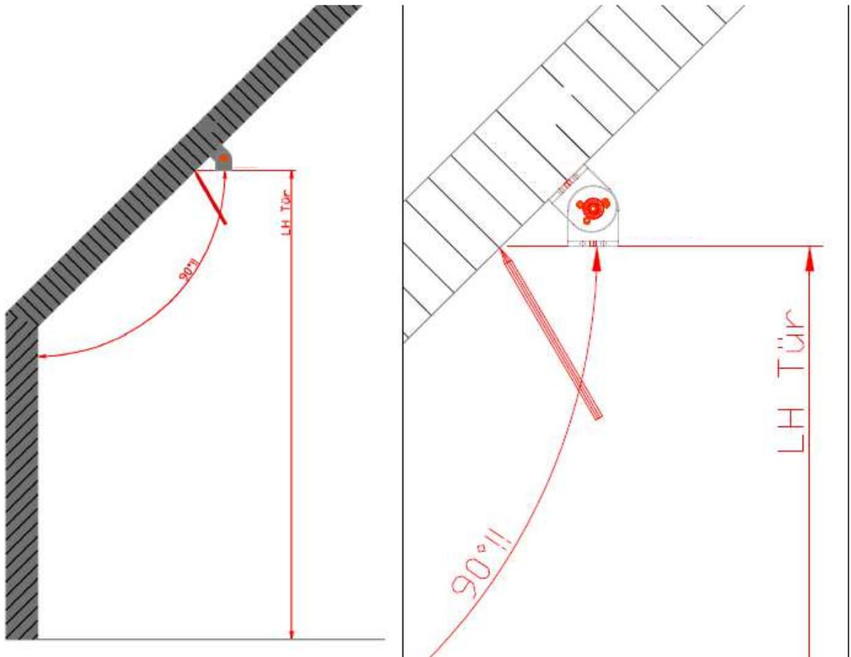
2. Die Deckenschiene wird unter den Kniestockwinkel befestigt:
