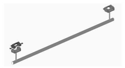
2.a. Die Kleiderstange mit den Winkeln an die Dachschräge halten und in die Waage bringen, Bohrungen anzeichnen und dem Untergrund entsprechend verschrauben.
