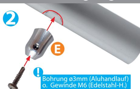
! Bohrung  $\varnothing 3\text{mm}$  (Aluhandlauf) o. Gewinde M6 (Edelstahl-H.)
