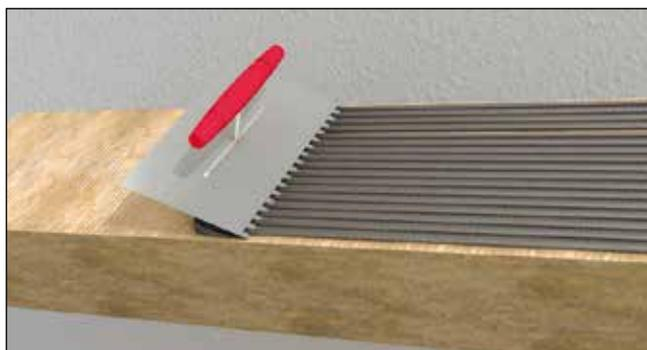
Abb. 18: Vollflächige Verklebung, schematische Darstellung anhand der Baumit Brandriegelplatte Mineral
