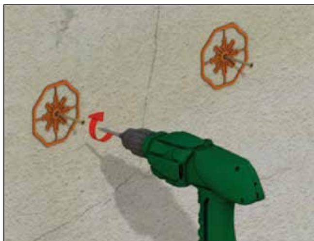
**Abb. 15: Setzen der Baumit KlebeAnker mittels Bohrschrauber**
