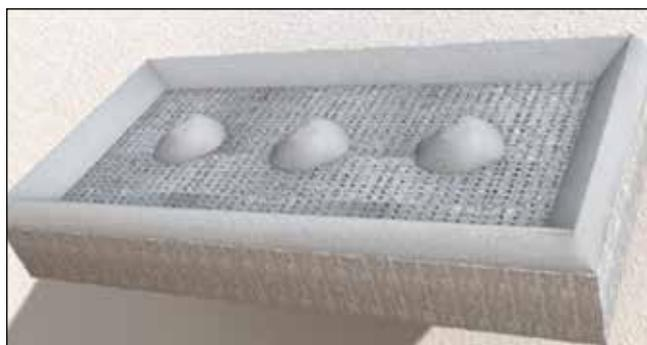
Abb. 17: Randwulst-Punkt-Methode, schematische Darstellung anhand der Baumit Fassadenplatte openair
