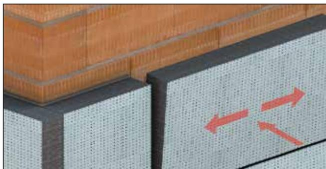
Abb. 19: Aufbringen der Dämmplatten
