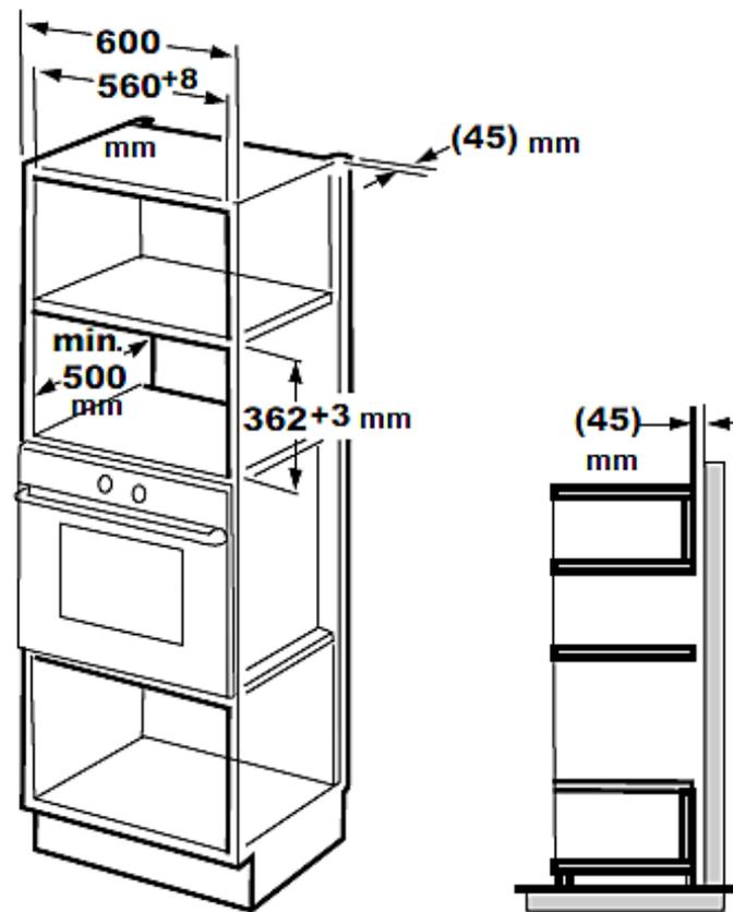
1. Die Einbauvorrichtung darf **keine** Rückwand hinter dem Gerät aufweisen.
