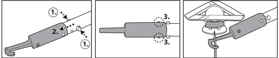
Heti kun robotti nousee veden pinnalle, etsi rungon alla oleva käsisymbolilla osoitettu kahva (katso alla oleva kaavio) helpottamaan laitteen poistamista altaasta. Pidä aina kiinni robotista tästä päästä, jotta roskat eivät putoa takaisin altaaseen laitteen poiston aikana.
