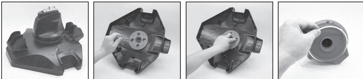
2. Använd skruvmejseln för att lossa de 4 skruvarna på undersidan av huvudet för att ta av den undre plattan först. Lossa sedan alla skruvarna vid basen enligt bildanvisningarna. Plocka bort fläkthjulet och band upp basen för att frilägga huvudet inuti.
