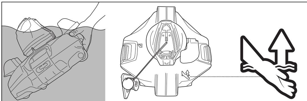
5. Coloque el interruptor en posición APAGADO. Enjuague el limpiafondos con agua limpia tras cada uso. NO use detergentes.
