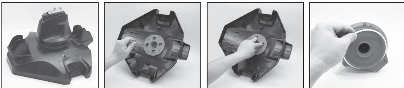
2. Pomocí šroubováku odšroubujte 4 šrouby umístěné ve spodní části hlavy, abyste nejprve uvolnili spodní desku. Poté odšroubujte všechny šrouby na základně, jak je znázorněno. Vyměňte rotor a vypáčením základny odkryjte vnitřek.
