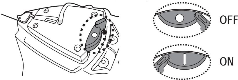
2. Fare leva sul cappuccio protettivo. Allineare e collegare la spina di ricarica alla porta di ricarica. **AVVERTENZA!** Assicurarsi di non invertire la spina di ricarica e assicurarsi che sia la spina di ricarica e la porta di ricarica siano puliti e asciutti prima di caricarli. **SUGGERIMENTI:** utilizzare un batuffolo di cotone per asciugare la porta di ricarica e i perni. Inserire il cavo di ricarica dell'adattatore esterno nella spina di ricarica.
