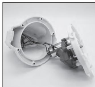
3. Verwijder de accu om bij de PCBA te kunnen. Druk op de clip van de connector en trek de connector weg om de voedingskabel van de batterij los te koppelen. **NB:** Wikkel onmiddellijk isolatieband rond de connector om kortsluiting tussen beide kabeluiteinden te voorkomen.
