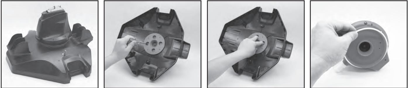
2. Utiliser le tournevis pour dévisser les 4 vis situées en dessous de la tête pivotante pour retirer la plaque inférieure. Utiliser le tournevis pour dévisser toutes les vis de la base comme indiqué. Retirer la turbine, puis soulever la base et la retirer pour exposer la partie intérieure.
