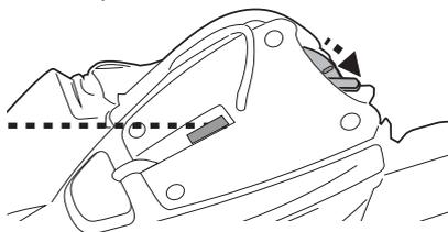
3. Posuňte vypínač do polohy „ON“ ( když je robot stále ponořen ) - rozsvítí se kontrolka a automaticky se aktivuje motor ( hladina vody zakrývající senzory v horní části otočné hlavy ). Nechte robota klesnout na dno bazénu a sledujte jeho první pohyby dopředu a dozadu na dně bazénu. Pokud se pohybuje podél stěny bazénu a ne kolmo, vytáhněte jej a znovu ponořte, přičemž se ujistěte, že jeho přední/zadní strana směřuje ke stěně bazénu.
