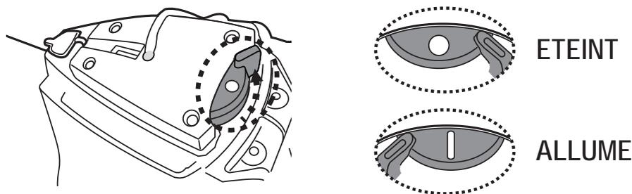
2. Soulevez la protection. Alignez et fixez la prise de charge au port de charge.
