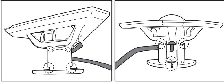
Правильная длина шнура должна соответствовать расстоянию между верхней частью робота и поверхностью воды. **ПРИМЕЧАНИЕ.** Из-за избыточной длины шнур может перекрутиться и, как следствие, повлиять на производительность.
