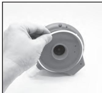
2. С помощью отвертки открутите 4 винта, расположенные в нижней части головки, чтобы сначала освободить нижнюю пластину. Затем открутите все винты у основания, как показано. Снимите лопастное колесо, подденьте и поднимите основание, чтобы обнажить головку внутри.
