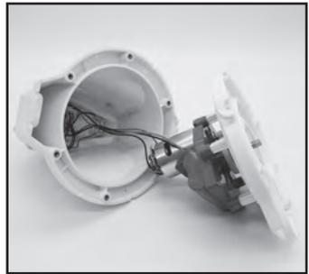
3. Retire o pack da bateria para exportar o PCBA. Para retirar o cabo de ligação da bateria, prima o clipe do conector para o puxar para fora. **NOTA:** Enrole o conector imediatamente com fita isoladora de modo a evitar qualquer curto - circuito causado pelo contacto de ambos os terminais de cabo.
