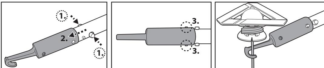
Assim que o robô alcançar a superfície da água, coloque a pega que está debaixo da base e indicada com o símbolo da mão ( ver diagrama abaixo ) para facilitar a recuperação da piscina. Certifique-se de que agarra sempre o robô a partir da extremidade para evitar que resíduos caiam para dentro da piscina durante a recuperação.
