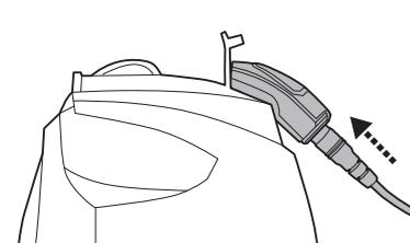
3. Conecte el adaptador externo a la fuente de alimentación. El indicador LED del adaptador externo se vuelve rojo después de que comienza la carga. El indicador LED del adaptador externo se vuelve verde cuando el robot está cargado.
