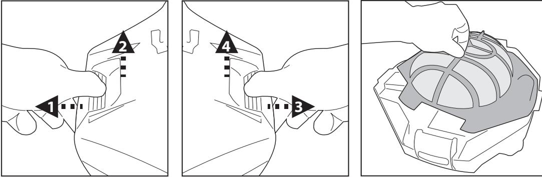
2. Maak het filterdeksel los en verwijder het vuil uit het compartiment. Het wordt aanbevolen om het filterdeksel schoon te maken met spatwater. Als borstelen noodzakelijk wordt geacht, gebruik dan alleen een zachte borstel om het filter voorzichtig te reinigen om beschadiging te voorkomen.
