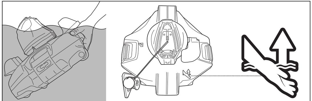
5. Liu'uta virtakytkin pois päältä -asentoon. Huuhtelee robotti puhtaalla vedellä jokaisen käytön jälkeen. ÄLÄ käytä mitään pesuainetta.
