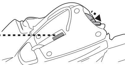
3. Skjut strömbrytaren till läget "PÅ" ( medan roboten fortfarande är under vattenytan ) – indikatorlampan tänds och motorn aktiveras automatiskt ( om sensorerna på svivelhuvudet är under vattenytan ). Låt roboten sjunka till poolens botten och kontrollera att den börjar köra fram och tillbaka över poolens botten. Om roboten kör längs med poolens vägg i stället för vinkelrätt mot den halar du in den och flyttar på den så att dess fram-/bakdel är riktad mot poolens vägg.
