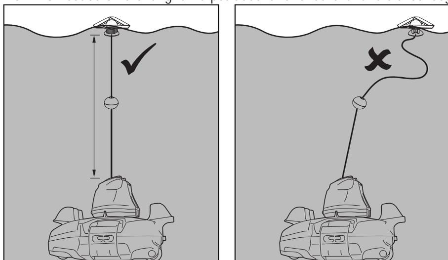
Innanzitutto, allineare e attaccare la fune di recupero attorno alle tacche laterali nella parte superiore mentre si avvolge la fune attorno al fusto ( **passo 1 & 2** ). Continuare ad avvolgere la fune attorno alla metà superiore dello stelo fino a raggiungere la lunghezza richiesta ( **passaggio 3** ). Tirare la fune verso il basso nella fessura inferiore e inserirla al suo interno ( **passaggio 4** ).
