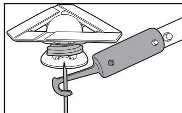
Jakmile robot dosáhne vodní hladiny, najděte úchop, který je pod základnou a je označen symbolem ruky ( viz obrázek níže ), abyste usnadnili vytažení z bazénu. Ujistěte se, že vždy uchopíte robota za tuto část, aby se zabránilo vypadání nečistot zpět na bazénu.
