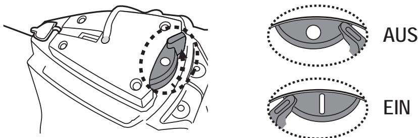
2. Öffnen Sie die Schutzkappe. Richten Sie den Ladestecker aus und schließen Sie es an den Ladeanschluss an.
