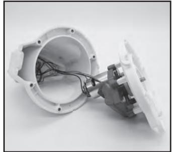
3. Irrota akku, jotta piirilevy näkyy. Irrota akun liitäntäjohto painamalla liittimen klipsiä ja vedä se ulos. **HUOMAA:** teippaa liitin välittömästi eristysteipillä, jotta vältetään molempien johtoliittimien kosketamisesta aiheutuvalta oikosululta.
