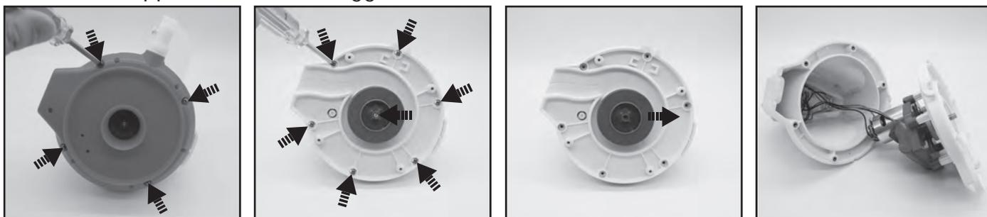
3. Ta ut batteripaketet för att exponera kretskortet. För att lossa batteriets anslutningstråd trycker du ned kontaktens klämma och drar ut den. **ANMÄRKNING:** Linda omedelbart kontakten med isoleringstejp för att undvika kortslutning orsakad av att de två trådanslutningarna kommer i kontakt med varandra.
