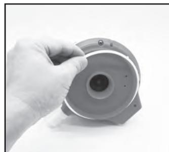
2. Gebruik de schroevendraaier om de 4 schroeven aan de onderkant van de kop los te schroeven om eerst de bodemplaat te verwijderen. Gebruik de schroevendraaier om alle schroeven op de basis los te draaien, zoals getoond wordt in de afbeelding. Verwijder de rotor, wrik de basis los en verwijder ze om tot de kop aan de binnenkant vrijkomt.
