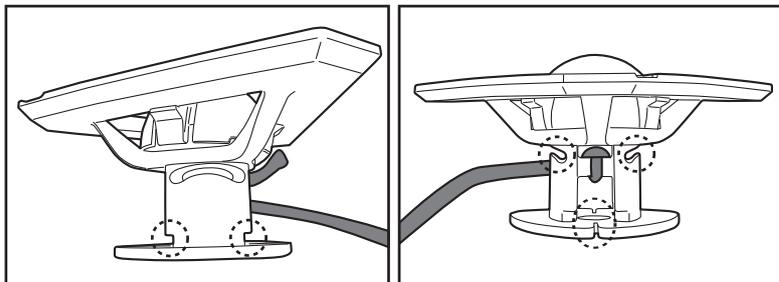
O comprimento correto do cabo deverá ser equivalente à distância entre o topo do robô e o nível de água.
