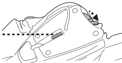
3. Skyv strømbryteren til «PÅ» ( mens roboten er i vannet ) – indikatorlyset slås på og aktiverer motoren automatisk ( vannstanden som dekker sensorene på toppen av det svingbare hodet ). La roboten synke ned til bassengbunnen, og observer de første bevegelsene fremover og bakover langs bassengbunnen. Hvis den går langs bassengveggen istedet for vinkelrett, hent den opp og sett den ut igjen samtidig som du sørger for at forsiden/baksiden vender mot bassengveggen.
