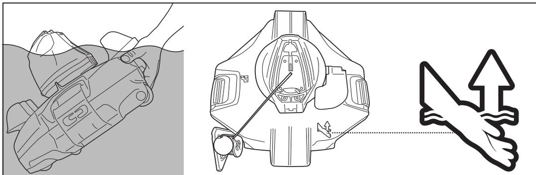
5. Scorrere l'interruttore sulla posizione OFF. Risciacquare il robot con acqua fresca dopo ogni uso. **NON** usare detersivi.
