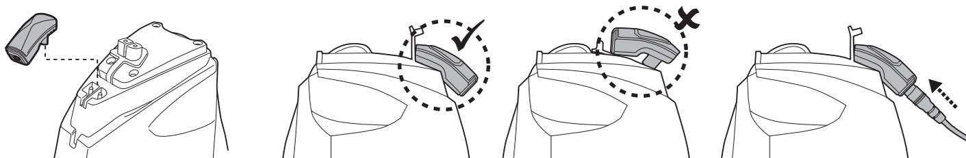
3. Anslut den externa adaptern till strömkällan. Indikatorlampan på den externa adaptern lyser rött när laddningen påbörjats. Indikatorlampan på den externa adaptern kommer att lysa grönt när roboten är fulladdad.
