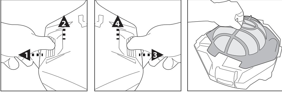
2. Irrota suodatinsuojus ja poista roskat säiliöstä. On suositeltavaa puhdistaa suodatinsuojus roiskuttamalla siihen vettä. Jos harjaus katsotaan tarpeelliseksi, käytä vain pehmeää harjaa huolellisesti ja varovasti vaurioiden välttämiseksi.
