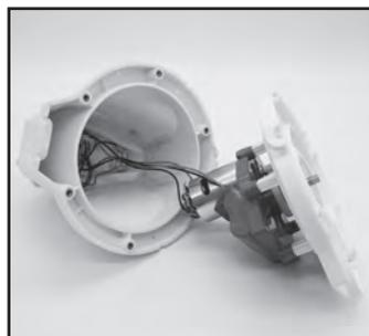
3. Saque el paquete de baterías para dejar el PCBA al descubierto. Para desconectar el cable de la batería, presione el clip del conector y tire de él. **NOTA:** Envuelva inmediatamente el conector con cinta aislante para evitar cortocircuitos causados por el contacto de ambos terminales.
