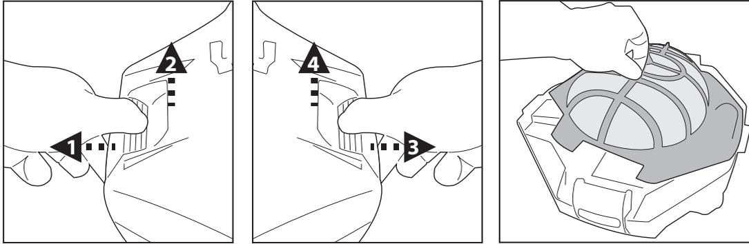
2. Retirer le filtre puis nettoyer le compartiment à débris. Il est recommandé de nettoyer le filtre à l'aide d'un jet d'eau. Si un brosseage est jugé nécessaire, utiliser seulement une brosse souple pour nettoyer délicatement afin de ne pas endommager le filtre. N'appliquer aucune pression sur le filtre.
