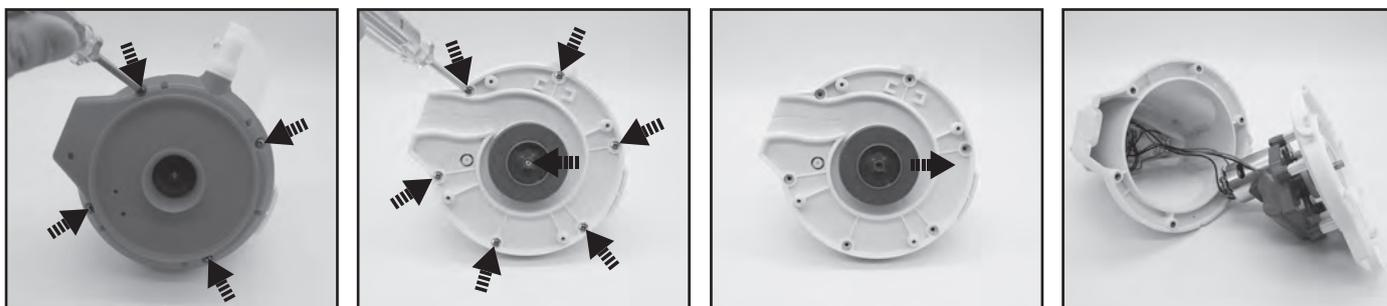
3. Vyměňte baterii, abyste odkryli desku plošných spojů. Chcete-li odpojit přípojovací vodič baterie, zatlačte na sponu konektoru a vytáhněte jej. **POZNÁMKA:** Konektor okamžitě obalte izolační páskou, aby nedošlo ke zkratu způsobenému kontaktem obou svorek vodiče.
