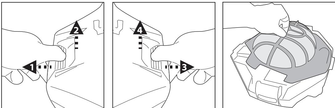
2. Rimuovere il coperchio e la piastra del filtro e rimuovere i detriti dal compartimento. Si raccomanda di pulire il coperchio del filtro e della piastra del filtro di drenaggio con acqua corrente. Se è necessario spazzolare, utilizzare esclusivamente una spazzola morbida per pulirlo delicatamente evitando di danneggiarlo.
