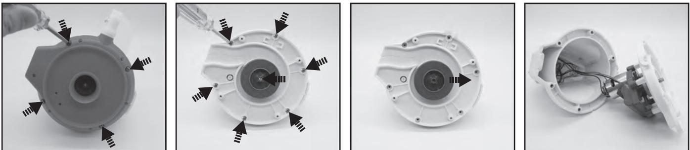
3. Akku herausnehmen, so dass PCBA zugänglich ist. Um die Anschlussdrähte vom Akku zu lösen, auf den Clip am Stecker drücken und dann herausziehen. **HINWEIS:** Umwickeln Sie den Stecker sofort mit Isolierband, um einen Kurzschluss durch einen Kontakt der beiden Drahtenden zu vermeiden.
