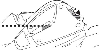
3. Liu'uta virtakytkin asentoon "PÄÄLLÄ" (robotin ollessa vielä veden alla) - merkkivalo syttyy ja moottori aktivoituu automaattisesti (vedenpinnan peitettävä kääntyvän yläkappaleen yläosassa olevat anturit). Anna robotin vajota altaan pohjaan ja tarkkaile sen ensimmäisiä eteenpäin ja taaksepäin - liikkeitä altaan pohjalla. Jos se kulkee altaan seinää seuraten eikä kohtisuoraan, nosta se ylös ja laita takaisin varmistaen, että sen etu- / takaosa on altaan seinää vasten.
