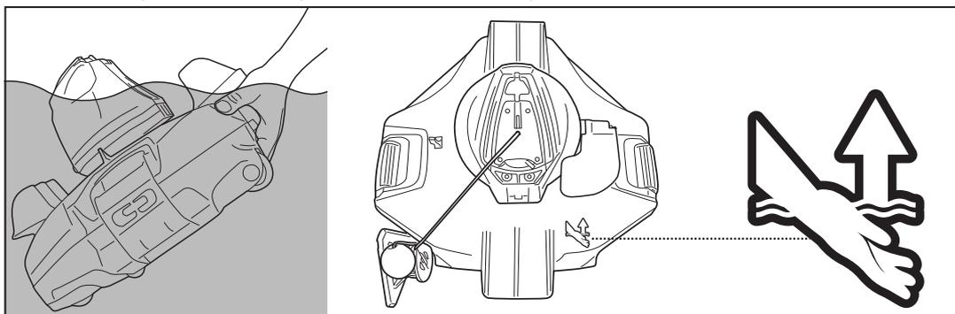
5. Desligue o interruptor para OFF. Lave o robô com água fresca a cada utilização. NÃO utilize qualquer detergente.
