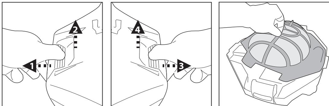
2. Vyndejte kryt filtru a odstraňte nečistoty z prostoru. Doporučujeme vyčistit sítko filtru proudem vody. Pokud považujete za nutné sítko kartáčovat, čistěte ji jemně, pouze měkkým kartáčem, a to tak, aby nedošlo k jejímu poškození.
