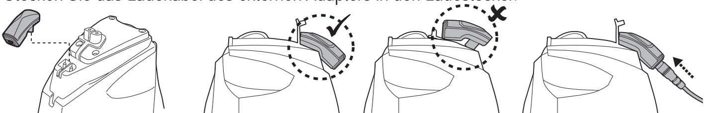
3. Verbinden Sie den externen Adapter mit der Stromquelle. Die Anzeigeleuchte am externen Adapter leuchtet rot, sobald der Ladevorgang beginnt. Die Anzeigeleuchte am externen Adapter leuchtet grün, wenn der Roboter aufgeladen ist.
