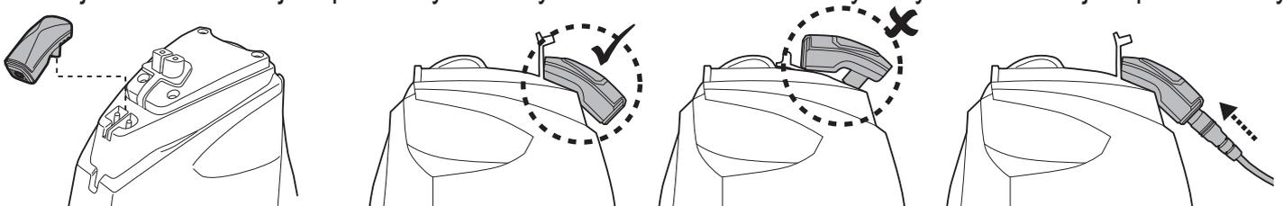
3. Připojte externí adaptér ke zdroji napájení. Jakmile se začne robot nabíjet, rozsvítí se kontrolka na externím kabelu zeleně.
