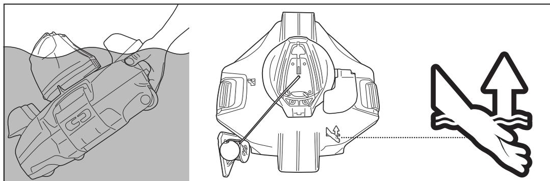
5. Positionner l'interrupteur sur la position ETEINT. Rincer le robot avec de l'eau fraîche après chaque utilisation. Ne PAS utiliser de détergent.
