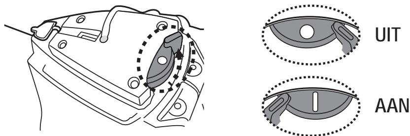
2. Wrik de beschermkap open. Lijn de laadstekker uit en bevestig deze aan de laadpoort.
