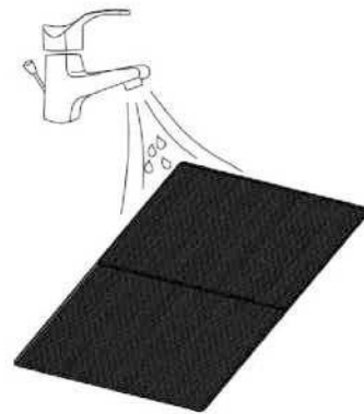
Fig. 2. Sciacquare il filtro sotto l'acqua corrente.
