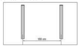
Hinweis: Es ist sehr wichtig, die Pfosten exakt lotrecht und in der richtigen Höhe zu setzen, bevor Sie mit der Montage beginnen. Damit legen Sie die Basis für eine exakte Montage. Beachten Sie dabei auch, dass der Abstand zwischen den einzelnen Pfosten von 180 cm innerhalb der Führungsschiene (Nut) der Pfosten gemessen werden muss. Die Profile haben eine Länge von ca. 179,3 cm um eventuelle vertikale Dimensionsveränderung der WPC-Lamellen ausgleichen zu können.
