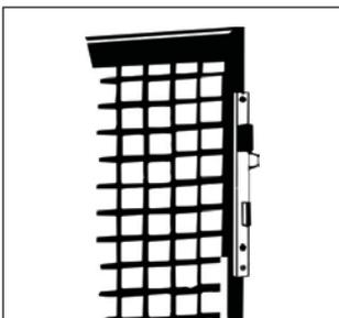
Jetzt können Sie das Rohrrahmenschloss, die Drücker und den Buntbarteinsatz einsetzen. Der Buntbarteinsatz kann auch durch einen Profilzylinder ersetzt werden.
