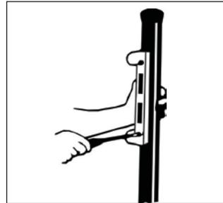
**TIPP:** Schieben Sie den Buntbarteinsatz komplett mit dem Schlüssel zusammen in die dafür vorgesehene Öffnung. Drehen Sie den Schlüssel um 180°, so dass der Schlüsselbart in den Schließmechanismus greift aber noch nicht ganz zugeschlossen ist. Jetzt können Sie den Buntbarteinsatz fixieren. Das lästige Justieren des Buntbarteinsatzes entfällt somit.
