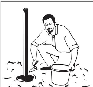
Erstellen Sie die Fundamentlöcher (ca. 30 x 30 cm im Quadrat, Tiefe je nach Torpfostenlänge, frostsicher bei ca. 80 cm). Beachten Sie, dass der Torflügel am Boden noch genug Spielraum zum Öffnen und Schließen des Tores hat. Torbreiten sind immer von Mitte bis Mitte Pfosten angegeben, d.h. die tatsächliche Torbreite ist um eine Pfostenbreite größer.
