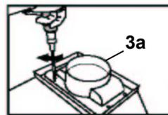
**4.** Haube an den Schrauben aufhängen und Schrauben festziehen
