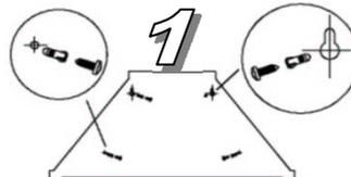
**2.** Schrauben bis auf ca. 10 mm in die Dübel schrauben
