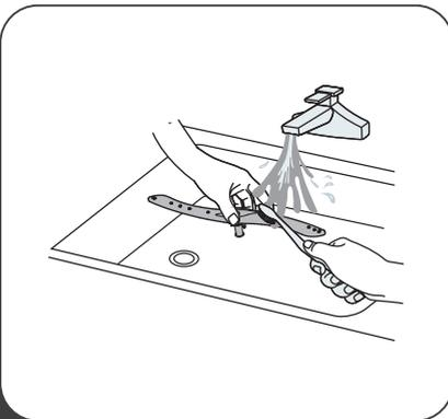
**3** Waschen Sie die Sprüharme in warmem Seifenwasser und reinigen Sie die Düsen mit einer weichen Bürste.
