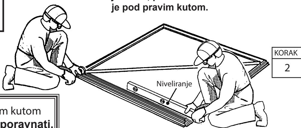
Podni okvir mora biti pod pravim kutom i niveliiran ili se otvor i neće poravnati.
