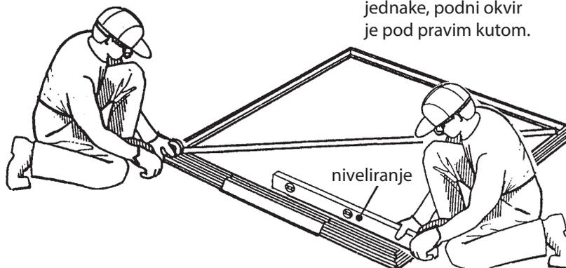
Podni okvir **mora biti pod pravim kutom i niveliran ili se otvori neće poravnati.**
