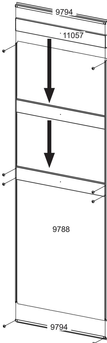
**2** Pomaknite **držač zasuna vrata** na sredinu **vrata** i pričvrstite ga s četiri (4) **vijka**. Zatim pričvrstite **horizontalne držače vrata** na svaki kraj **vrata** pomoću dva (2) **vijka** na svakom držaču.
