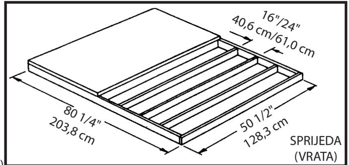
**Napomena: Platforma/ploča mora biti šira za 9/16" (1,4 cm) od podnog okvira na sve četiri strane. Zalijte tih 9/16" (1,4 cm) drveta cementom za glazure (nije isporučen) ili ukosite tih 9/16" (1,4 cm) betona prilikom lijevanja radi dobrog odvoda vode.**
