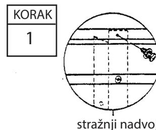
Pazite da sva bočna preklapanja budu pričvršćena jednim vijkom.
