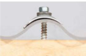
Bei Kunststoffüberdachungen sind die Befestigungen immer auf die Wellenberge zu setzen. Wellplatten der Marke PLEXIGLAS® PRO TERRA 2,8 mm und HEATSTOP werden mit Hilfe von Spezialschrauben und Kalotten befestigt. Für Wellplatten unter 1,8 mm Stärke benötigen Sie zusätzlich Abstandhalter oder Schaumwellprofilleisten, die für die nötige Steifigkeit sorgen. Schaumwellprofilleisten vermindern zusätzlich die Geräuschübertragung und dienen als Windschutz.
