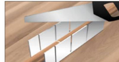
Beim Zuschneiden der Leisten ist auf die Gehrung oder evtl. Verbindungsstücke zu achten. Je nach Montagesystem verlängert (bei Gehrung) bzw. verkürzt (Verbindungsstücke) sich die Leistenlänge.
