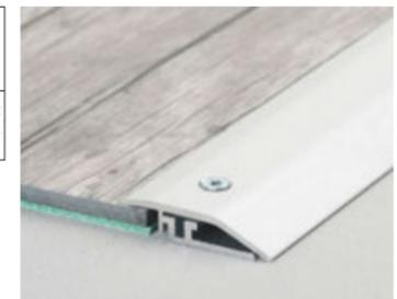
Schraubsystem, Aluminium. Inklusive Basisprofil und Befestigungsmaterial. Für Belagstärken 3,5 – 8,5 mm. Höhenausgleich von 8,5 mm bis auf 0 mm.
