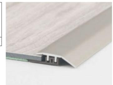
Clipssystem, Aluminium. Inklusive Basisprofil. Für Aufbauhöhen von 4 – 7,5 mm. Höhenausgleich von 7,5 mm bis auf 0 mm.
