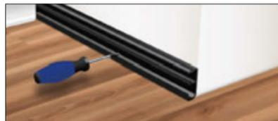
Montage der schraubbaren Trägerleiste
