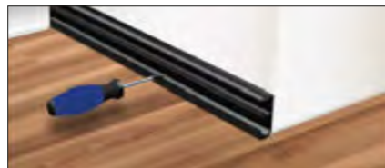
Montage der schraubbaren Trägerleiste
