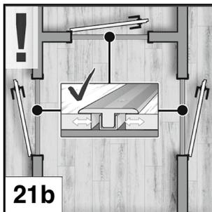
Bei Verlegeflächen mit mehr als 8 m Länge bzw. Breite und bei stark verwinkelten Räumen sind Dehnungsfugen (mind. 2 cm Breite) erforderlich [21a]. Nur dann kann sich der Boden
