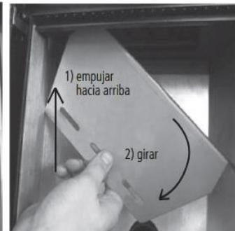
Fig. 17: extracción de la placa cortafuego
