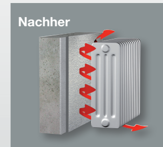
Gedämmte Heizkörpernische; kaum Energieverlust
