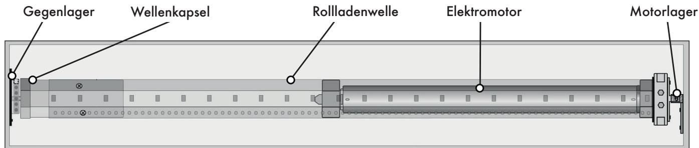
Abb. 1 - eingebauter Motor
