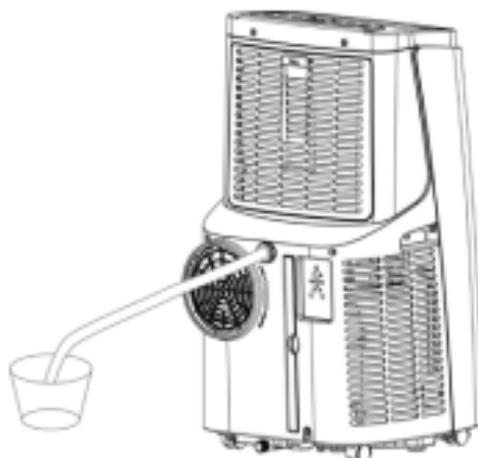
**Aviso:** reinicie el producto después de instalar el tapón de agua y la cubierta de desagüe (como se muestra en la imagen), de lo contrario, el agua de condensación del producto se saldrá.
