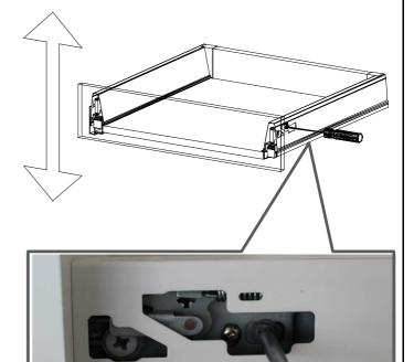
Mit Betätigung der vorderen Schraube wird die Fronteinstellung in horizontaler Richtung vorgenommen!
