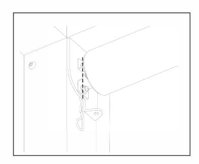
**Schritt 5:** Stecken Sie die Führungsstangen durch die oberen Halterungen, die Seitenmarkise und die unteren Führungsbuchsen und befestigen Sie diese mit den Hutmuttern
