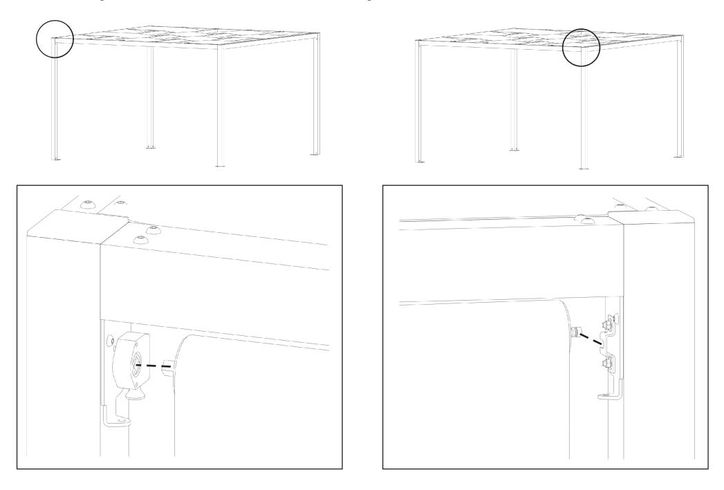
Schritt 4: Sichern Sie die Seitenmarkise mit dem Splint.
