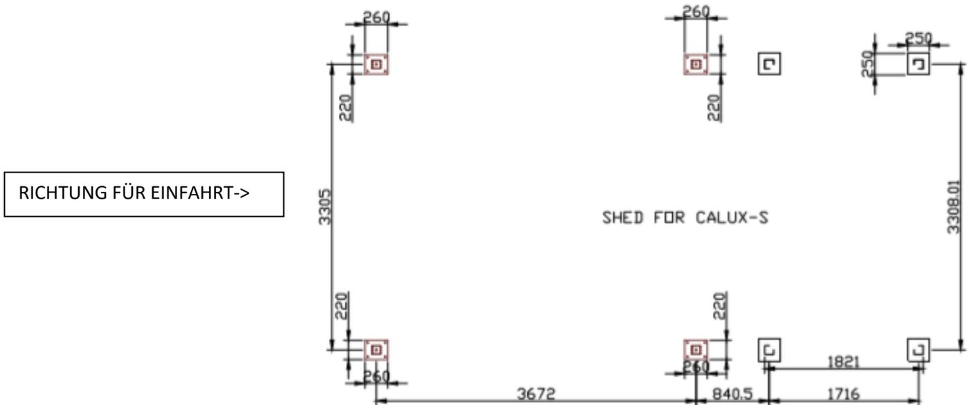
Das Fundament (minimum 400x400 mm Oberfläche ) giessen, damit die Beine des Carport auf ein vernünftiges Areal befestigt werden können. Das Fundament muss in frostfreie Tiefe gegossen werden (min. 80cm). Das Fundament muss eine Neigung von 1-2 cm über die gesamte Länge haben damit das Regenwasser abfließen kann. Die Ablaufröhre müssen an dem Ende liegen wo der Carport 1-2cm tiefer liegt.
