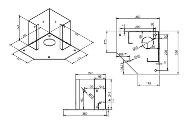
Fussplatte Ø95 für die Kupplung von Ablaufröhren zum Abfluss. Rohr muss ins Fundament gegossen werden.
