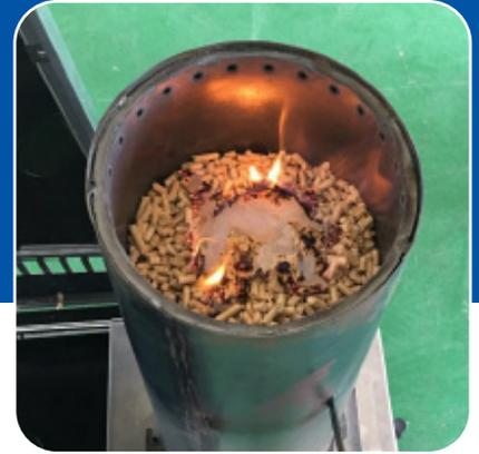
Encender la pastilla y esperar unos 5-8 minutos para asegurarse de que el pellet esté completamente encendido.
