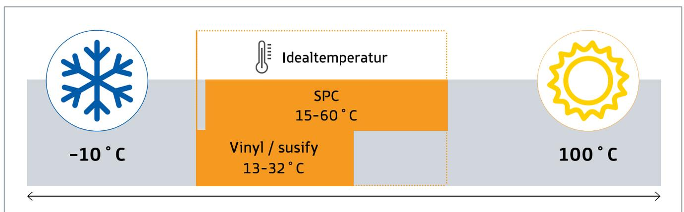
Die maximale Oberflächentemperatur von 60 °C bei SPC-Böden und von 32 °C bei Vinyl-/susify-Böden darf nicht überschritten werden. Außerdem muss ein sehr schneller Aufheizvorgang vermieden werden.
