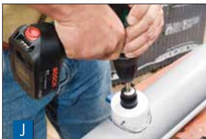
Das Ausschneiden des Ablaufloches geht schnell und sauber mit einem Lochsägeaufsatz oder einer feinzahnigen Säge.
