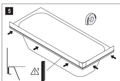
**!** Schalldämmband mit Zollstock faltenfrei anpressen.
