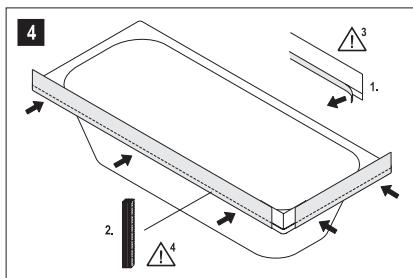
**!** Vor Aufkleben des Wannenranddichtbandes die Schutzfolie gleichmäßig abziehen.
