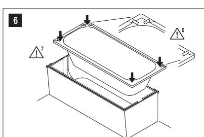
**!** Vor Einsetzen der Badewanne das Wannenranddichtband mit Klebebandstreifen auf dem Wannenrand fixieren.
