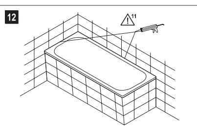
**11** Ausführung der Fuge gemäß IVD\_Merkblatt Nr. 3, Hinterfüllmaterial verwenden.
