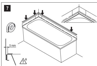
**!** Schalldämmband mit mind. 5 mm Abstand zum Wannenranddichtband aufkleben.
