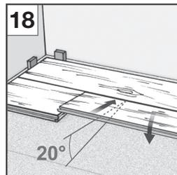
Die zweite Reihe mit einem halben Paneel (Länge ≤ 95cm) oder eben diesem Rest (Länge ≥ 30 cm) beginnen [15, 16]. Das Panellstück dabei längsseitig in die Nutprofilierung der 1. Reihe einlegen und arretieren/abwinkeln [16, 17]. Der Querfugenversatz muss von Reihe zu Reihe jeweils bei min. 30 cm liegen.
