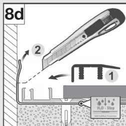
Die Randabdichtung erfolgt, indem die Dampfbremssolie ausreichend in die Vertikale an angrenzende Bauteile gezogen wird. Nach der Montage der Abschlusschiene mit Deckprofil, wird die Folie oberhalb des Deckprofils bündig abgeschnitten **[8d]**.
