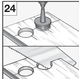
Für Heizungsrohre müssen Lochbohrungen, die 3 cm größer sind als der Rohrdurchmesser, ausgespart werden. „Einpassstück“ aussägen, bekleimen, einpassen und mit einem Keil bis zur Aushärtung des Leimes fixieren. Anschließend Aussparungen mit Heizkörpermanschetten verkleiden [23, 24, 25].
