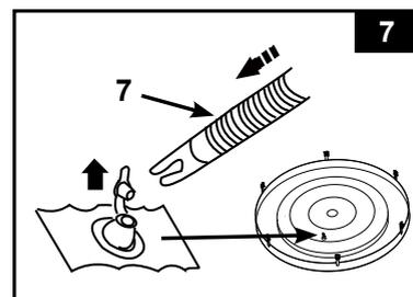
**NOTA:** Si fuera necesario agregar más aire a la pared de la bañera del spa o a la cámara de la cubierta después de instalarlas, consulte las secciones "Inflado de la pared de la bañera del spa" y "Inflado de la cámara de aire del spa". La cámara de aire interior está preinstalada en el cobertor del spa. Si fuera necesario volverla a colocar, primero colocar la cámara vacía dentro de la capa del cobertor del spa y, entonces, hincharla.
