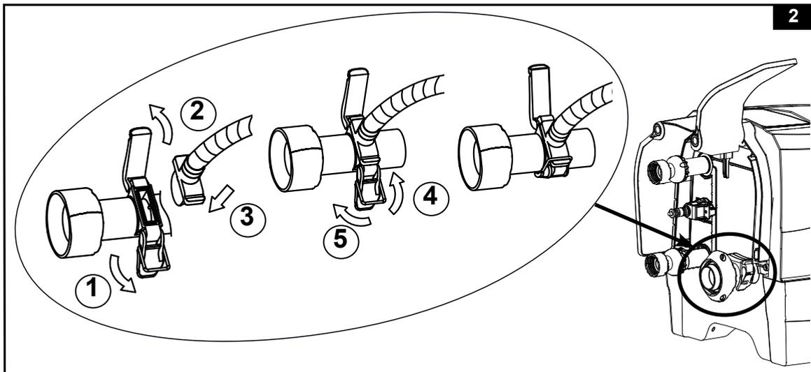
3. Desenrosque la válvula de aire del spa para dejar a la vista el vástago en posición erguida para inflar. Inserte el otro extremo de la manguera de inflado (7) en la válvula y gírelo hacia la derecha para bloquearlo en su posición (vea el dibujo 3).
