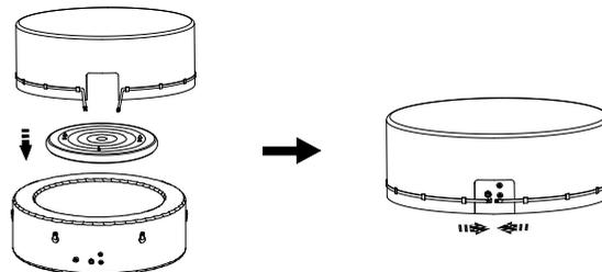
**NOTA:** Si la vejiga de aire de la cubierta del spa no encaja en el spa debido a que está demasiado inflado, deje salir algo de aire de la vejiga hasta que encaje.
