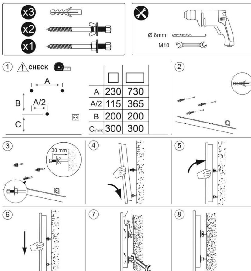
⚠ Verificare le misure e il livello prima di perforare. Dimensioni in mm
