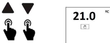
Po zvolení ručního režimu stiskněte tlačítko **ECO** pro snížení teploty místnosti o 3° C.
