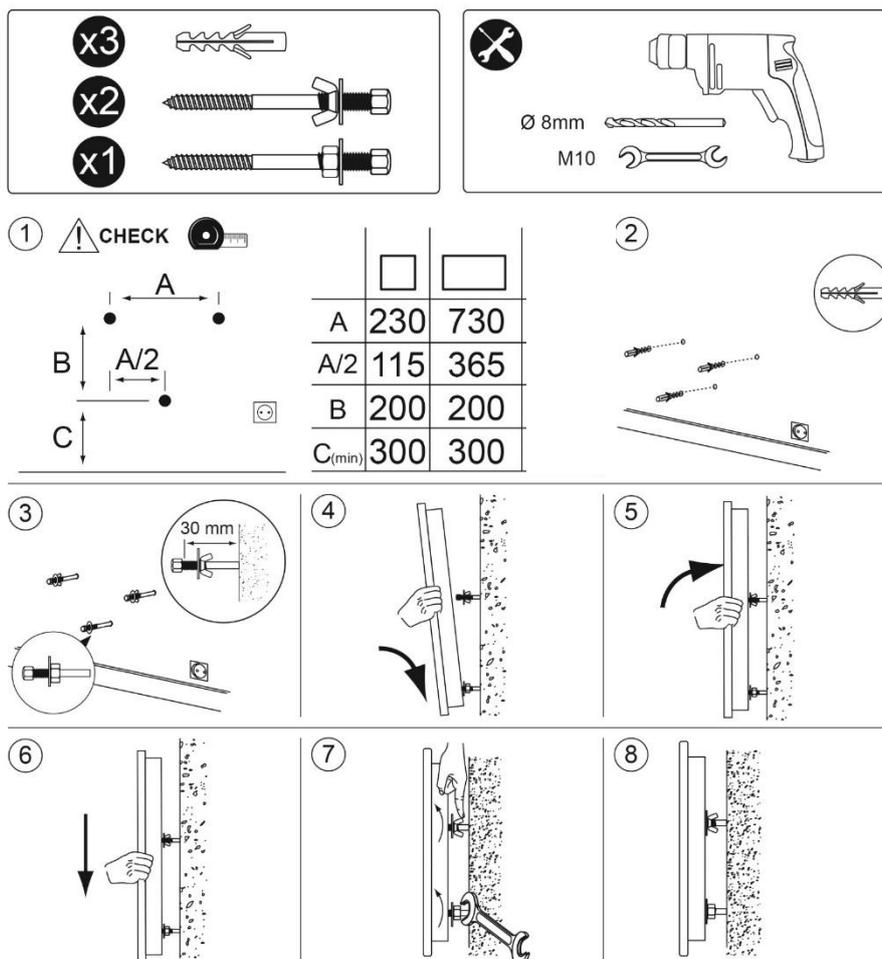
⚠ Před vrtáním zkontrolujte rozměry a vyrovnaní. Rozměry v mm
