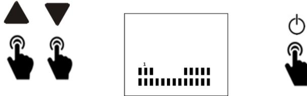
Kezdje a 0h-ot, nyomja meg az ▲ ▼ gombot a hőmérséklet kiválasztásához: comfort<sup>0h</sup>, eco<sup>0h</sup> vagy anti frost<sup>0h</sup>.
