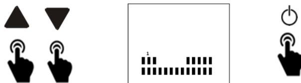
Začněte v 0h, stisknutím vyberte teplotu: komfort <sup>oh</sup>, eco <sup>oh</sup> nebo antifrost <sup>oh</sup>
