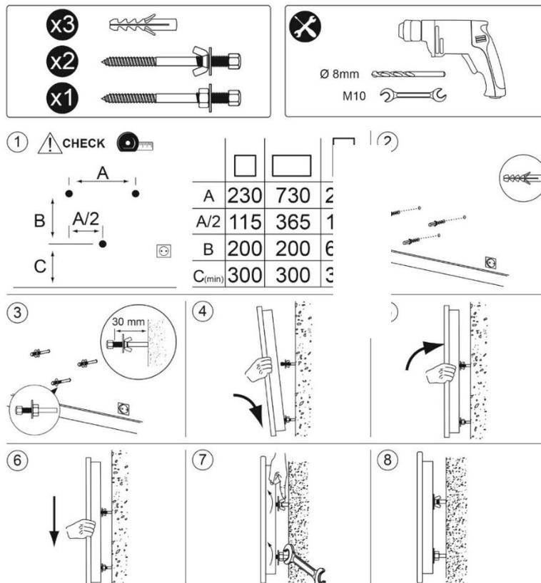
⚠ Controleer maatregelen en nivellering voor het boren. Metingen in mm
