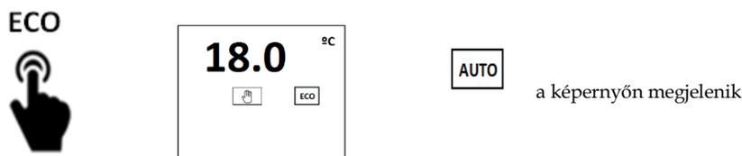
Nyomja meg ismét az **ECO** gombot a komfort hőmérséklet megfordításához
