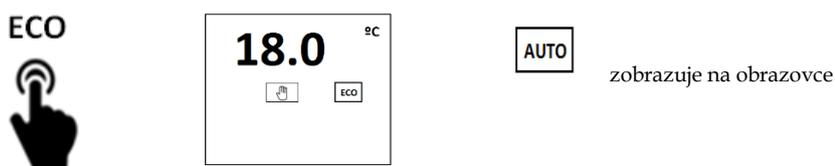
Opětovným stisknutím tlačítka **ECO** přepnete na komfortní teplotu
