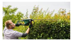
Vorderer Handgriff mit mehreren Greifpositionen ermöglicht bequemes Arbeiten in jeder Position
