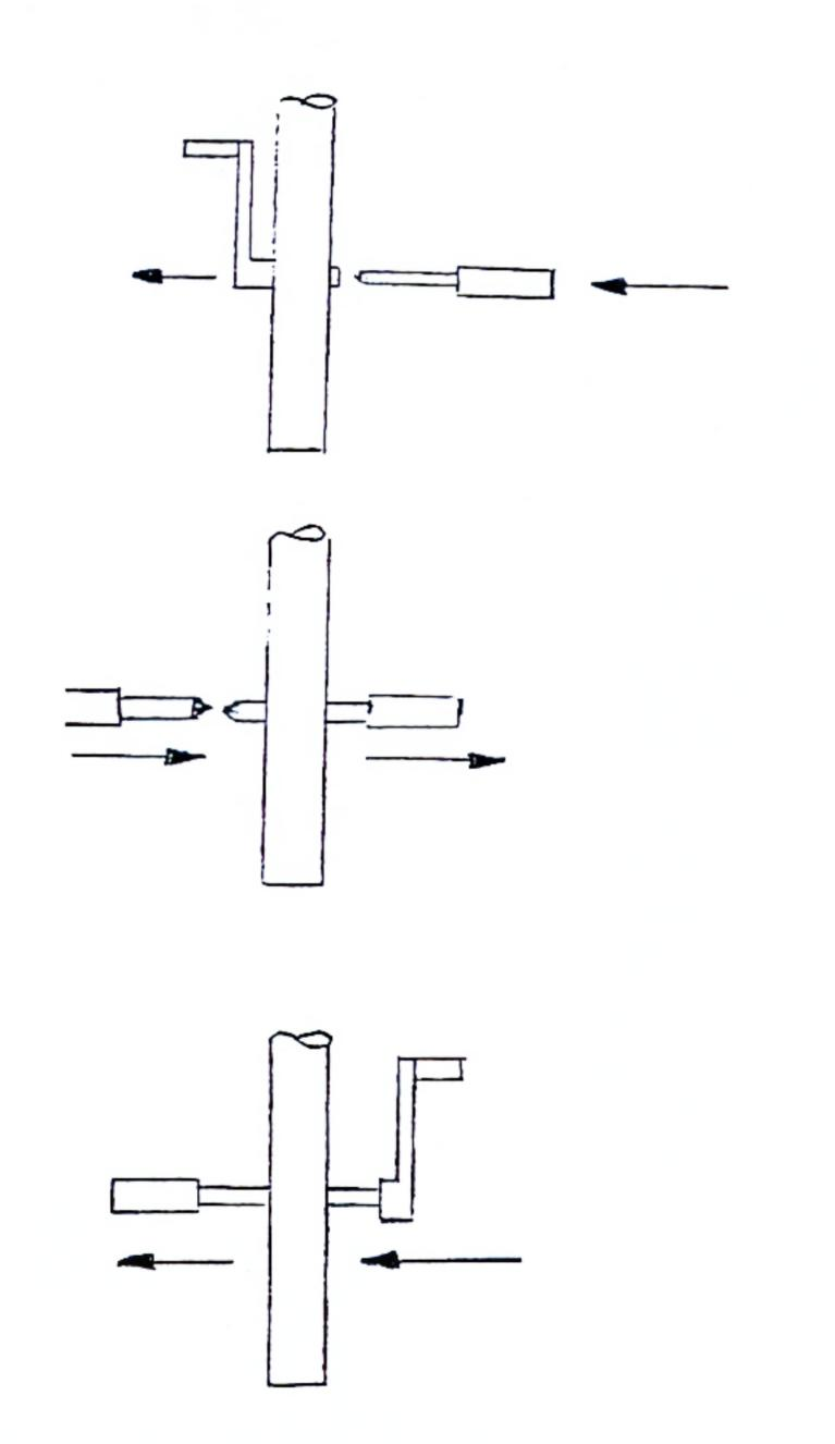
1. Nach lösen der Mutter die Kurbel vorsichtig herausziehen. Gleichzeitig von der anderen Seite Schraubendreher 1 nachschieben.
