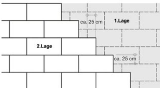
Abb. 21: Zweilagige Verlegung der Dämmplatten
