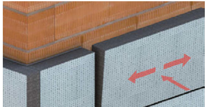
Abb. 20: Aufbringen der Dämmplatten
