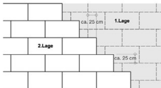
Abb. B.5: Verlegung der Dämmplatten / Verlegeraster
