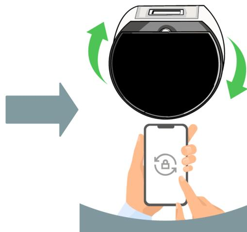
**Achtung:** Dadurch, dass sich der Zylinder auf der Außenseite immer **in eine Richtung drehen** und in die **andere Richtung sperren** lässt, ist es möglich, die Türe von außen **zuzusperren ohne** sich zuerst **authentifizieren** zu müssen. **Stellen** Sie bei der Ersteinrichtung daher unbedingt **sicher**, dass die **Öffnungsrichtung richtig eingestellt** ist und so nur das Zusperrern ohne Authentifizierung möglich ist – siehe 3.3. *Ersteinrichtung*.
