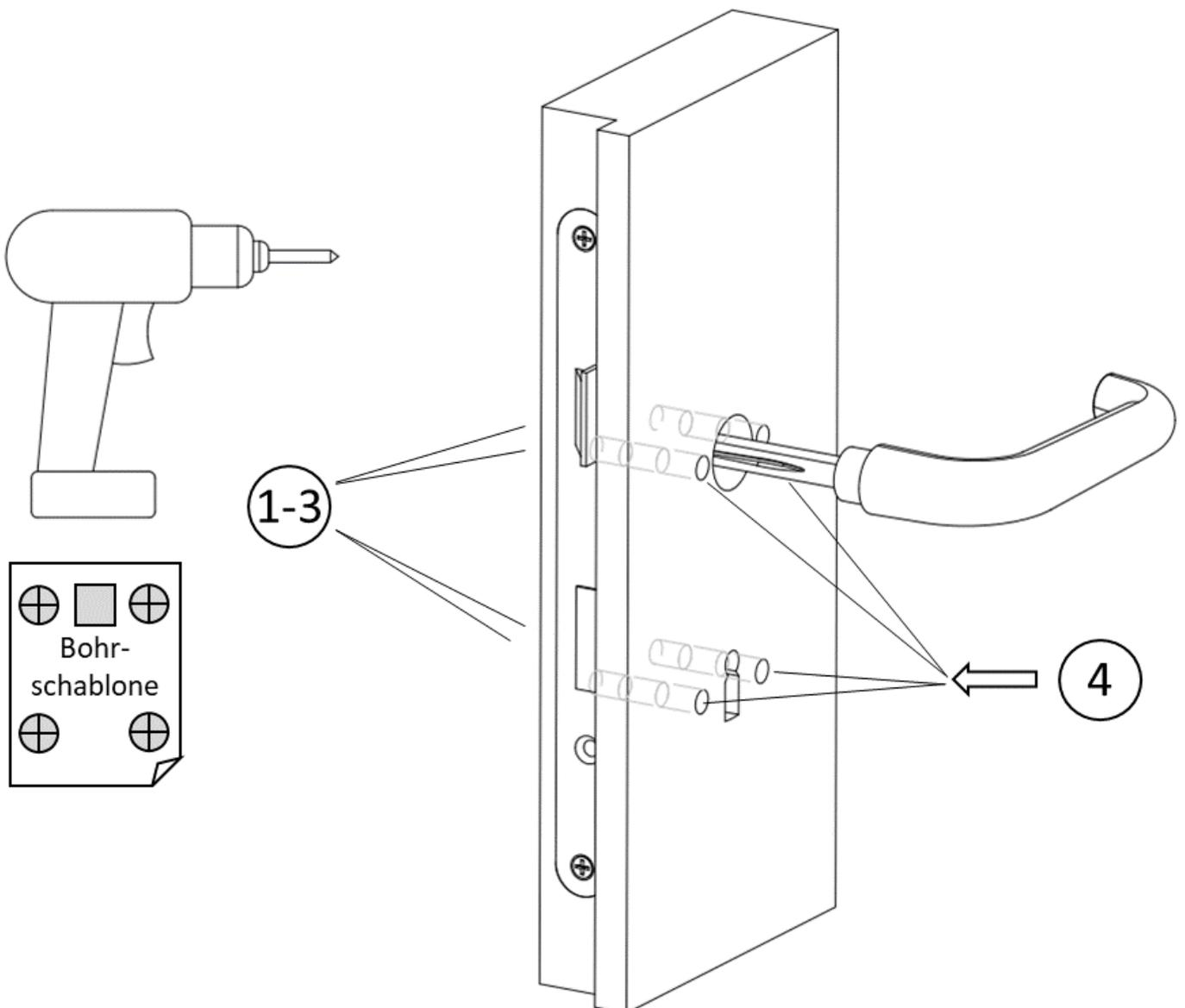
5. Die 4 Rosetten (2x Nr. 1 und 2x Nr. 2) mit jeweils einer Schraube befestigen. Dazu die Kappen abnehmen und nach dem Verschrauben wieder aufstecken
