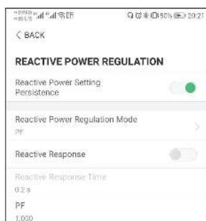
Figura 7-17 Regulación de potencia reactiva
